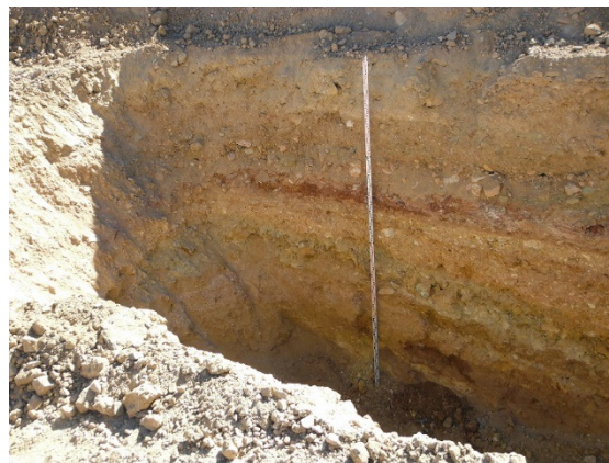
Foto 8-4: BS Calicata. poniente, Pl. El. 1.141,00 msnm, 2018.05.17 (regla de 4,00 m extendida)
