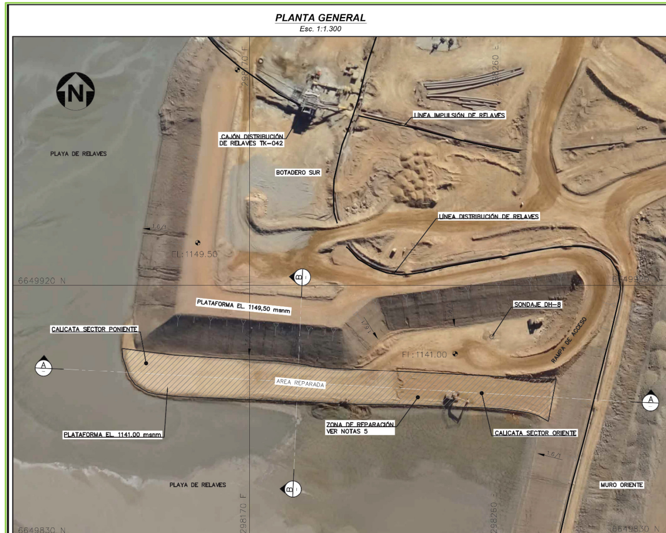
2018.05.15 BS: Sello de fundación reparación PL El. 1141,00 msnm, BS
